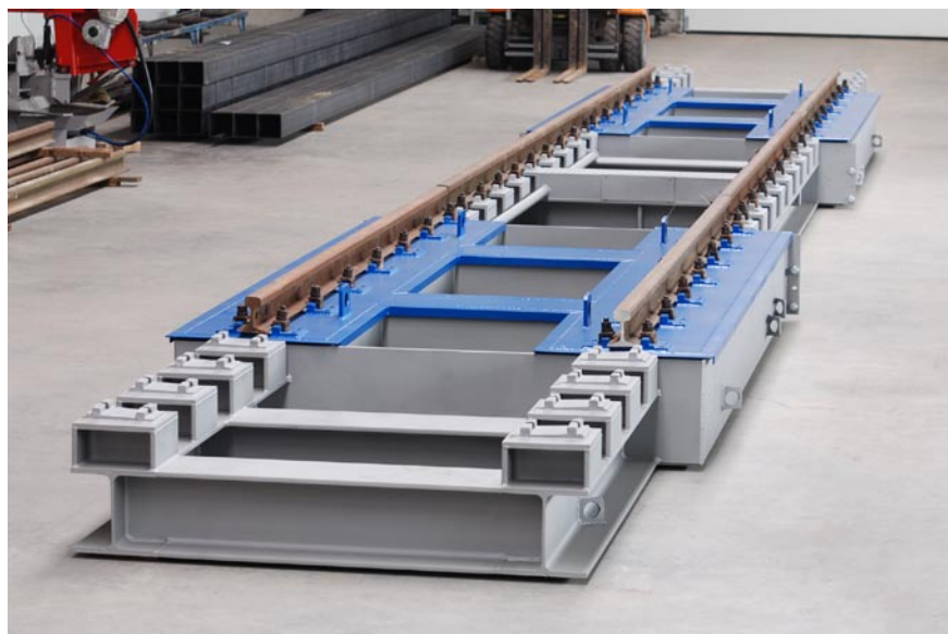
Waga kolejowa Mars-K400, przygotowana do instalacji w MTMG Gdynia
